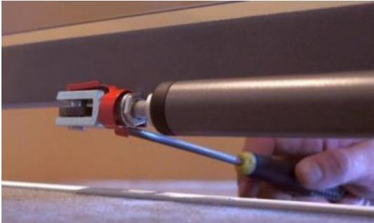
1. Sortir le ressort de l'axe de la manille avec un outil approprié, comme un tournevis, une règle, un ouvre-bouteille, etc.
